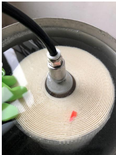
检漏，标记漏点
